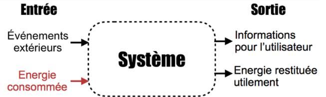
L'information provient soit des **IHM** soit des **capteurs**, pour contrôler automatiquement ou manuellement le fonctionnement physique par des **actionneurs** et transmettre des informations aux utilisateurs.
